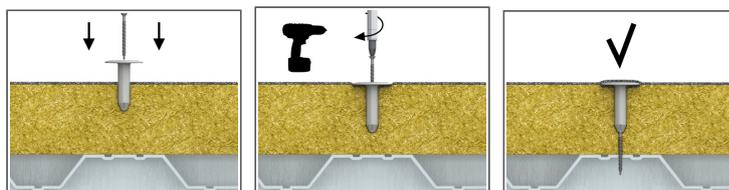
1. Selezionare un tipo di vite adatta per il materiale di supporto
